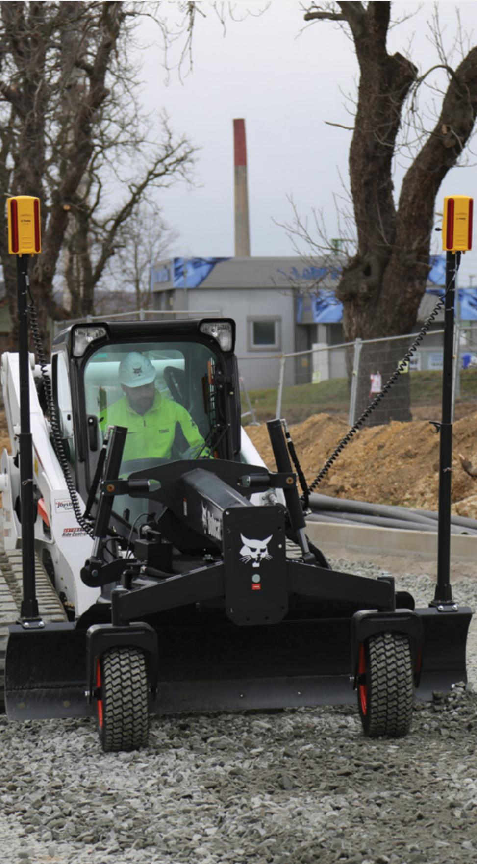
Trimble Earthworks GO! может использоваться для профилирования плоских и простых склонов в рамках общестроительных работ, работ по подготовке строительной площадки и устройству инженерных коммуникаций. В системе используется лазерная технология, которая передает динамическую информацию о местоположении в режиме реального времени оператору, что позволяет ему быстро и точно выполнять профилирование или выравнивание.
